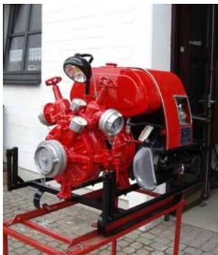
Links im Bild die Renovierte Tragkraftspritze aus dem Jahr 1963, sie wird im Einsatzdienst noch als Reservepumpe eingesetzt.
